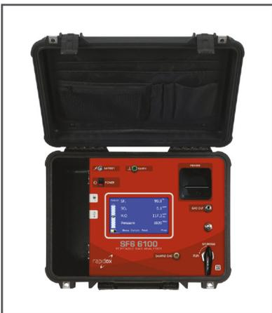
분석기는 맞춤형 테스트 파라미터를 생성할 수 있는 기능을 통해 현재 사용 중인 모든 IEC 및 CIGRE 테스트 구성으로 사전 프로그래밍됩니다. 모듈형 설계로 요청 시 맞춤형 센서 조합이 가능합니다.
